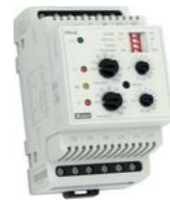
hlídá nadproud a podproud v AC nebo DC obvodech ve 3 rozsazích, 2x nezávislé výstupní kontakty
