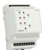
ADC3-60M Převodník analog-digital
